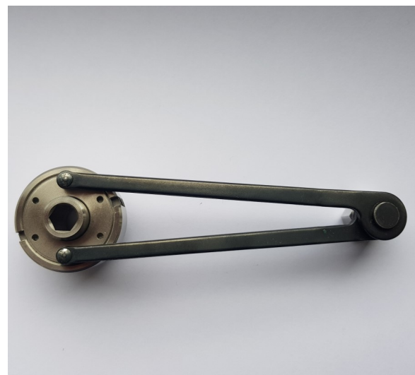
Abb.: Rutschkupplung mit Stirnlochschlüssel
